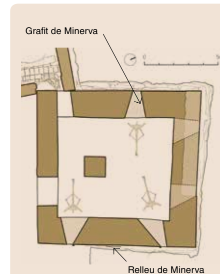
Planta de la cambra interior de la torre, amb posició de les balistes. La presència del gran pilar permet suposar l’existència d’una segona cambra superior.
