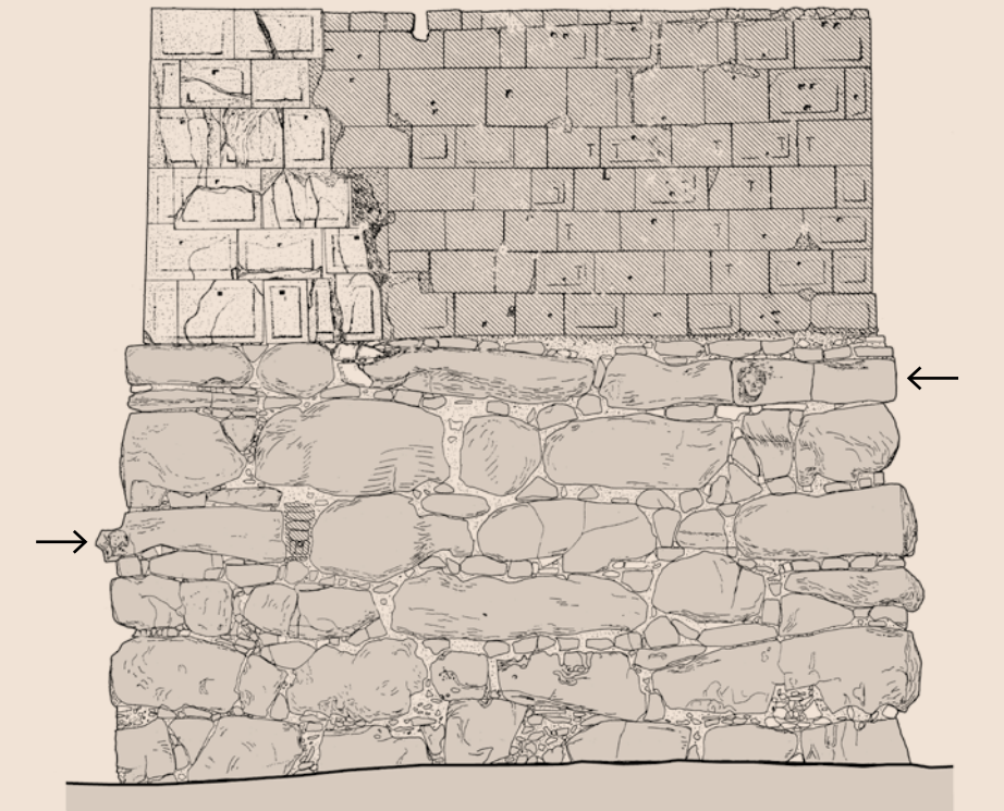
Alçat frontal de la torre de Minerva. Els blocs ratllats en diagonal corresponen a la reconstrucció medieval. Les fletxes assenyalen els blocs decorats amb caps tallats. Theodor Hauschild | Ricardo Mar
